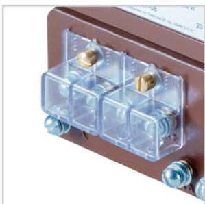
Вторичные выводы могут быть защищены прозрачной крышкой, что обеспечивает безопасность обслуживающего персонала, а также позволяет пломбировать клеммы для предотвращения несанкционированного доступа, что важно при коммерческом учёте электроэнергии.
